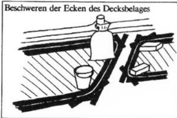
Jetzt müssen die Ecken des Antirutsch-Belages so angepreßt werden, daß sie sich nicht mehr lösen können. Dies kann durch Sandsäcke, Steine oder Wassereimer erreicht werden. Als Unterlage sollten Zeitungen gelegt werden, damit das Abklebeband(180) nicht beschädigt wird.
