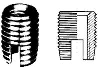
Gewindemuffen M-Gewinde im Gfk erstellen
