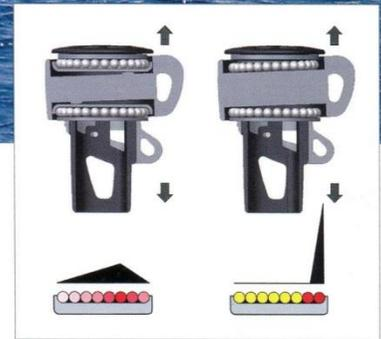
Der Lastverteiler schützt vor Punktbelastung einzelner Lagerkugeln!
