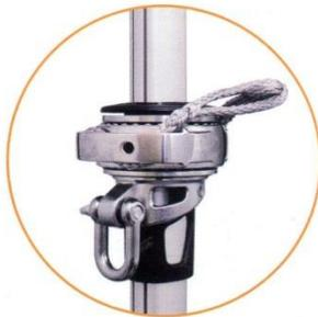
Der Fallschitten der Furlex 104S bis 404S dreht sich auf einem Lager aus nicht rostendem Stahl. Die Zuglast des Falls wird über zwei Dyneema-Augen zentriert.
