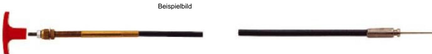
Der **Stoppzug** ist ein hochwertiges und leichtgängiges Kabel für Druck (max.35kg) und Zugkraftübertragung (max.70kg) zwischen Schalthebel und Maschinenanlage. Mit einer rostfreie Innenseele mit aufgewalzten Gewindeterminals, dazu stahlarmierte Nylonhülle mit patentiertem Innenackant für Leichtgängigkeit.
