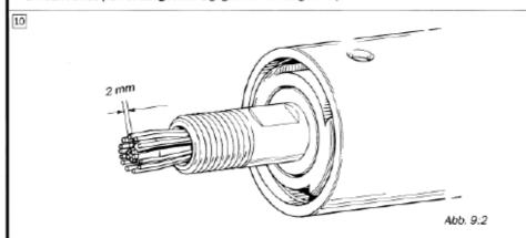
Drücken Sie das Drahtseil mit Konus in den festen Teil des Terminals damit die Aussendrähte, gleichmässig um den Konus verteilt, fixiert werden.
