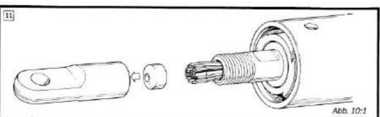
Legen Sie die konische Scheibe in den äusseren Terminalteil und schrauben Sie das Terminal zusammen, sodass sich das Drahtseil zwischen den Konen formt.
