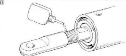
Tropfen Sie einige Tropfen Loc-Tite auf das Gewinde und schrauben Sie das Terminal wieder zusammen. Ziehen Sie fest mit dem Schraubenschlüssel an. Dieses ist eine permanente Verschraubung. Vermeiden Sie es, Loc-Tite auf die Haut zu bekommen.
