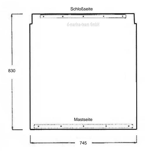
Die Bohrungen mit einem Holzbohrer erstellen
