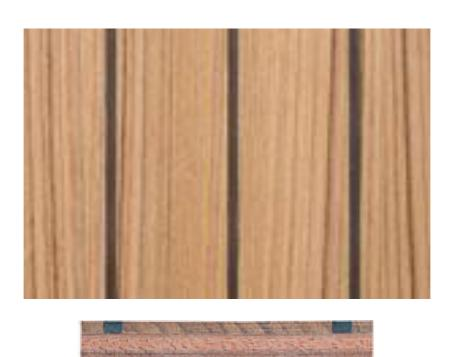
Einseitig-Teak ca. 3,0 mm Sägefurnier mit Gummifugen, Fugenabstand 45:4:45 mm etc., Innenlagen aus Okoumé, Rückseite Schälfurnier, gem. EN 636-3, Verleimung AW 100. Verwendungsbereich: Fußböden, Belag für Backskisten und Decks belag. Ideal für GFK-, Stahl-, Alu- und Holzdecks. Achtung: Kantenschutz ist unbedingt erforderlich!
