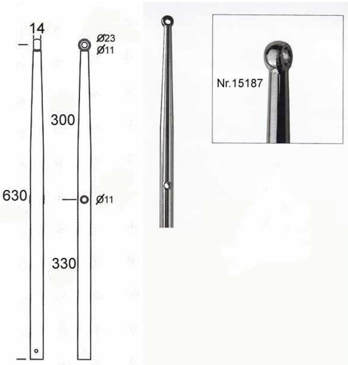
Nr.15187 Relingsstütze für den Bolzen Nr.14550 mit d=20,5mm
